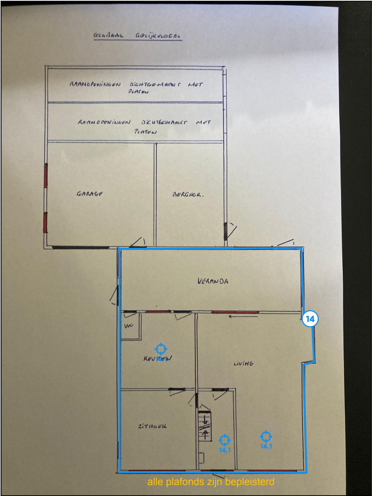
Legende van plan 1.6: gelijkvloers (pleisterwerk plafonds)
