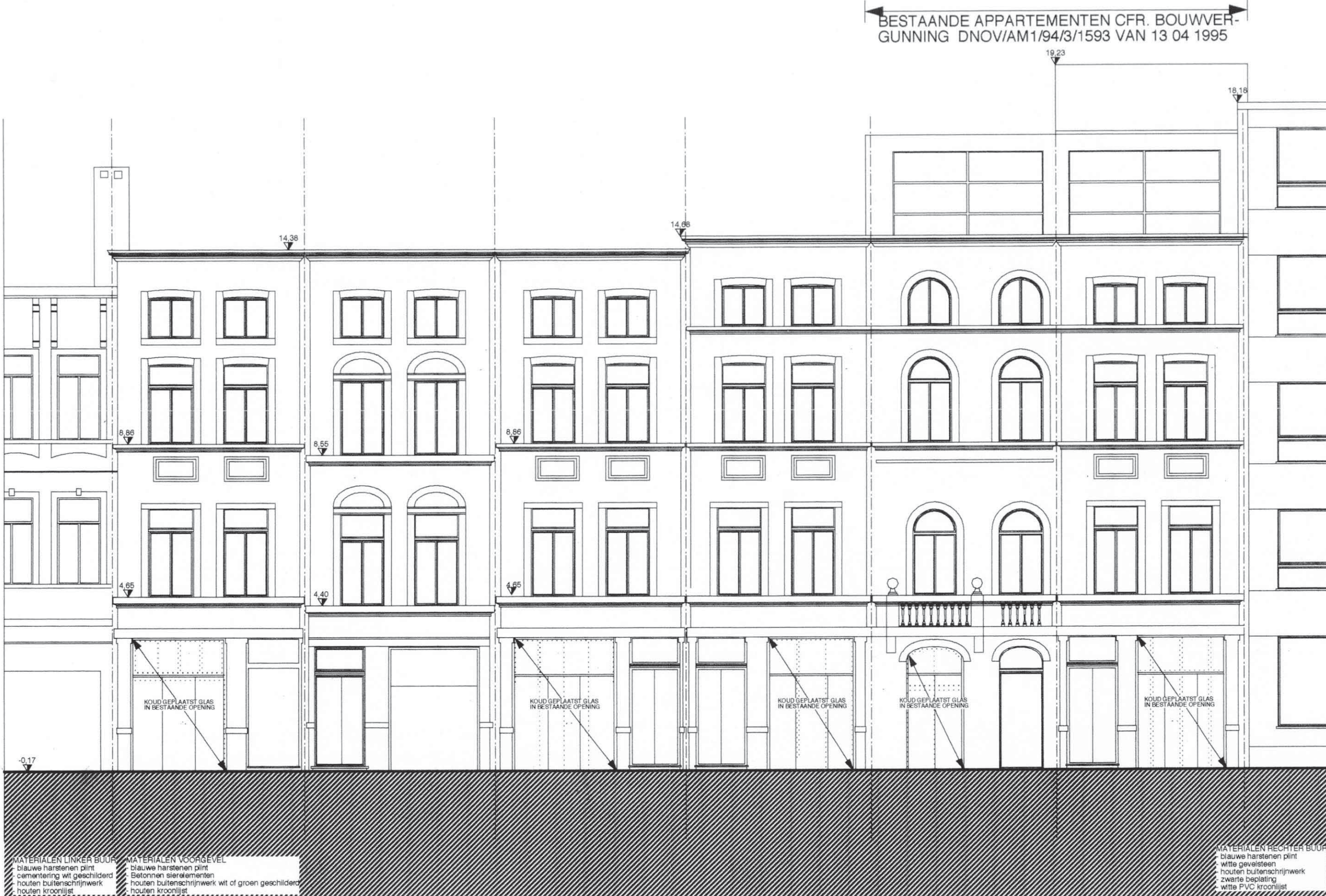
VOORGEVEL (wordt niet gewijzigd, enkel de deuren op nivo 0 worden vervangen door koud geplaatst glas) schaal 1/100
