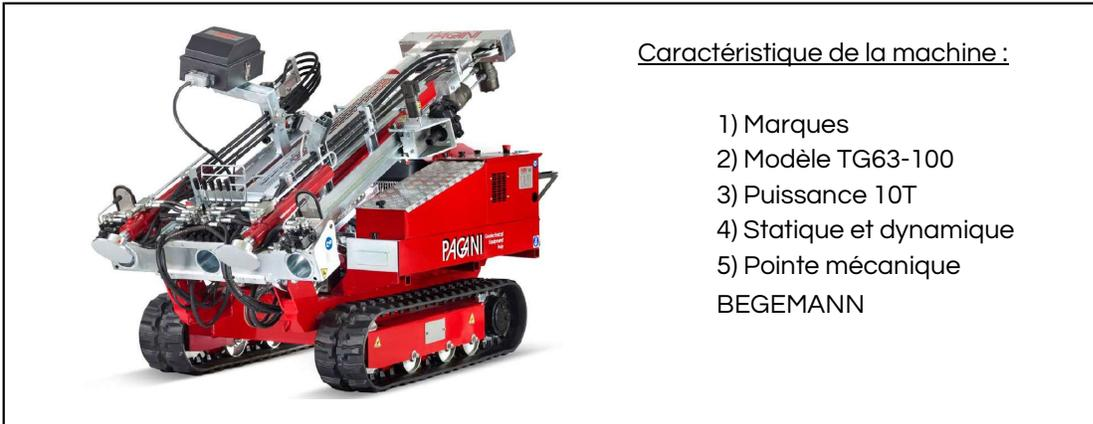
Lors de l'enfoncement, les mesures suivantes sont mesurées par pas de 20 cm :
