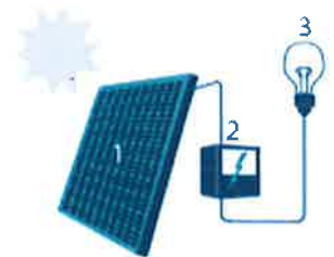
1. Zonnepaneel | 2. Omvormer | 3. Elektrische toestellen
