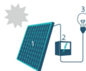
1. Zonnepaneel | 2. Omvormer | 3. Elektrische toestellen
